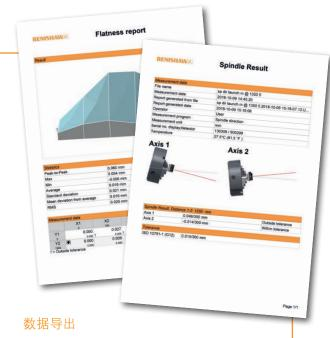
每次完成测量后,XK10软件会生成详细的测量报告。报告可通过USB(电缆或记忆棒)以PDF和XML格式导出。
