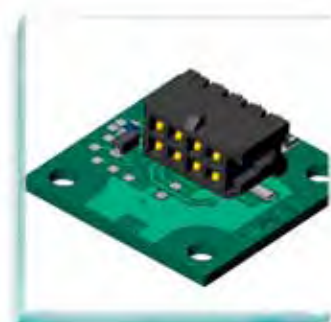
RMB29 运动控制磁编码器，经过重新设计后安装到板载SMD插头上
